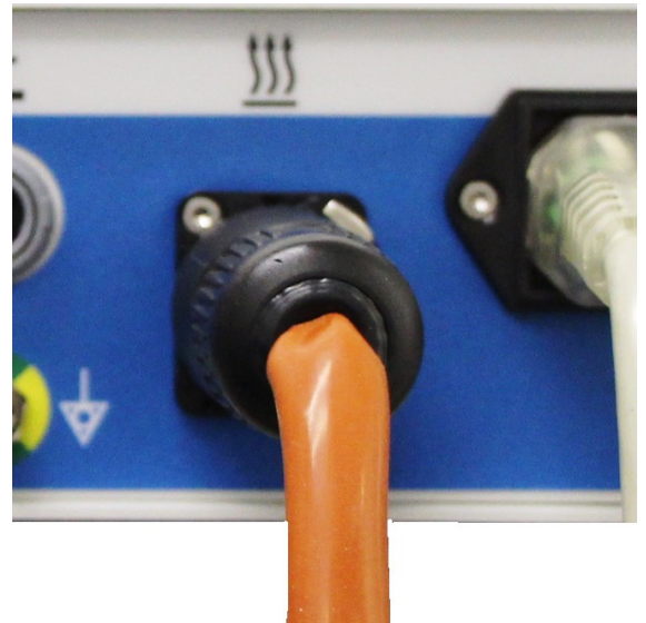
Figura 9: Ligue o cabo da banda de aquecimento à tomada
