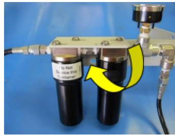
Figura 23: Remoção do compartimento de filtro
