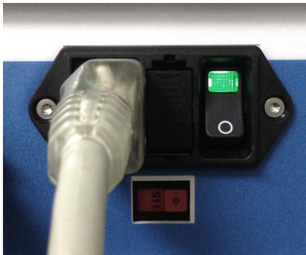
Figura 10: Ligar a AtriCure cryoICE BOX com o interruptor
