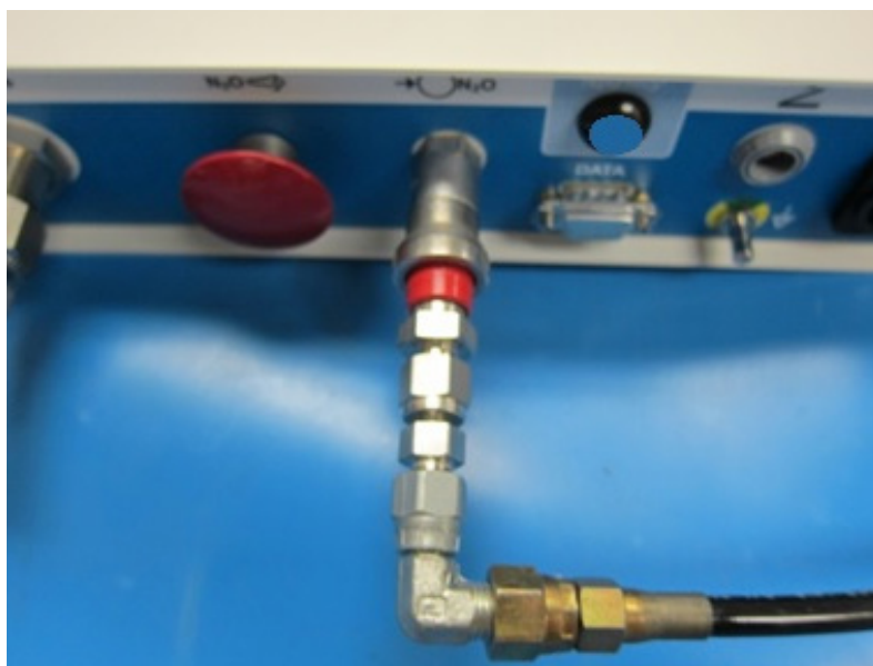
Figura 4: Ligação de entrada de N 2 O
