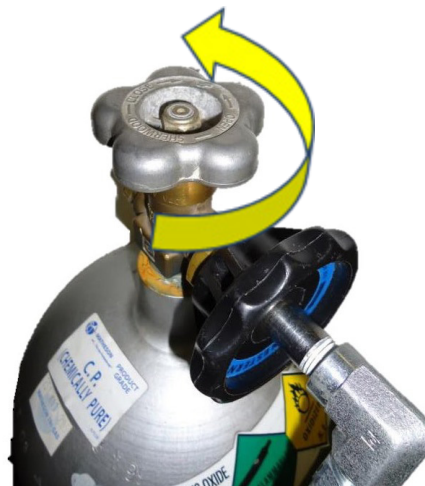
Figura 6: Rode a válvula no sentido contrário ao dos ponteiros do relógio para abrir
