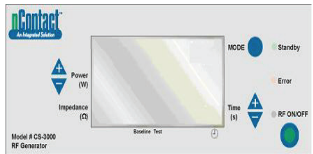
Slika 8. Zaslom na prednjoj ploči RF-generatora u načinu rada „Power On“
