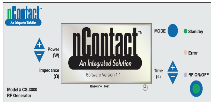
9. ábra Az RF-generátor előlapjának kijelzője „Készenlét” állapotban
