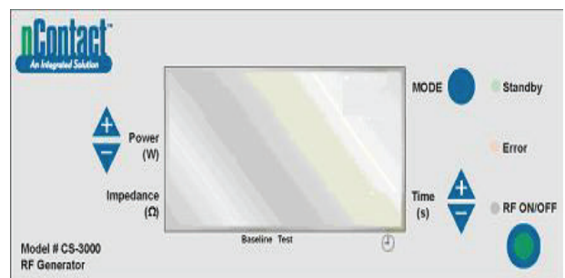
Figura 8. Paraqitja e panelit të përparmë të gjeneratorit RF kur ndizet "Power On"
