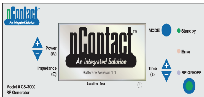
Figura 9. Paraqitja e panelit të përparmë të gjeneratorit RF në modalitetin "Standby"
