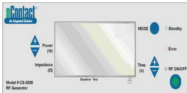
Figura 8. Display del pannello anteriore del generatore a RF "all'accensione"
