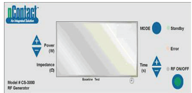
Figure 8. Affichage du panneau avant du générateur RF lors de la mise sous tension
