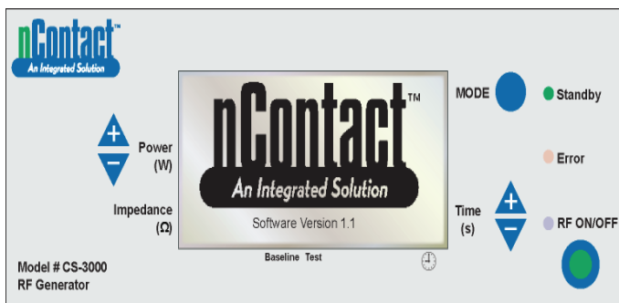
9. attēls. RF ģenerators priekšējā paneļa displejs režīmā "Standby"
