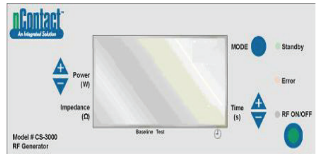
Obrázok 8. Displej predného panela RF generátora pri „zapnutí“
