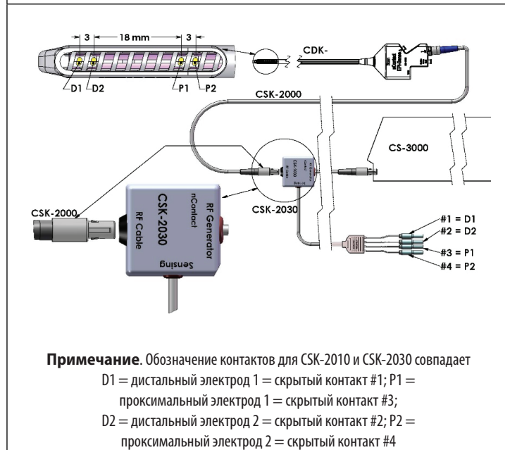
Рис. 6В. Устройства типа CDK, CSK-2000, CSK-2030 с конструктивным блоком и настройка РЧ-генератора
