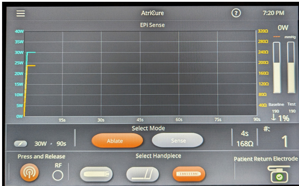
FIGURE 12. ÉCRAN DE PIÈCE À MAIN EPI-SENSE — IMPÉDANCE
