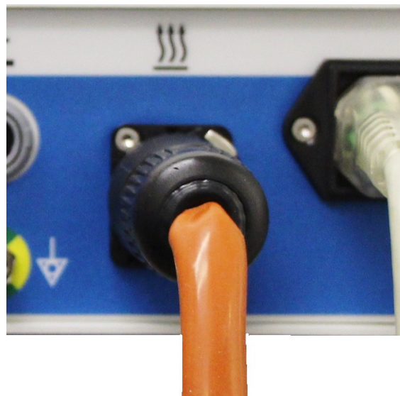
FIGURA 9: CONECTE O CABO DA BANDA DE AQUECIMENTO NA TOMADA
