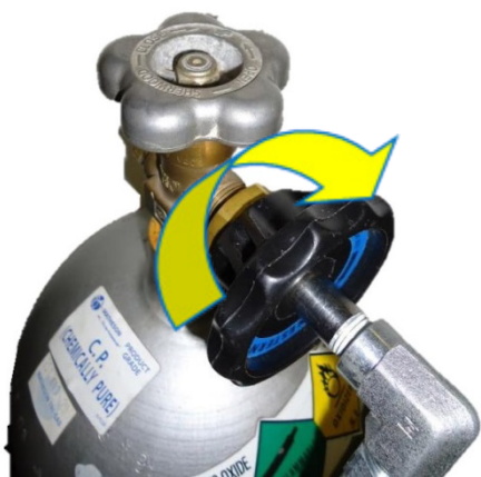
FIGURA 5: CONECTE O ACOPLADOR ESPECÍFICO DO PAÍS À CONEXÃO ROSQUEADA
