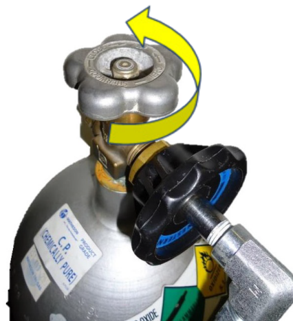
FIGURA 6: GIRE A VÁLVULA NO SENTIDO ANTI-HORÁRIO PARA ABRIR
