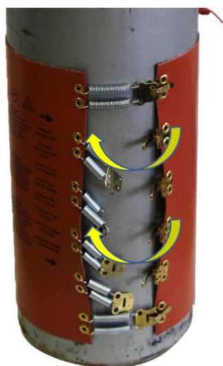
FIGURA 8: FIXE TODOS OS RETENTORES DA MOLA TENSORA
